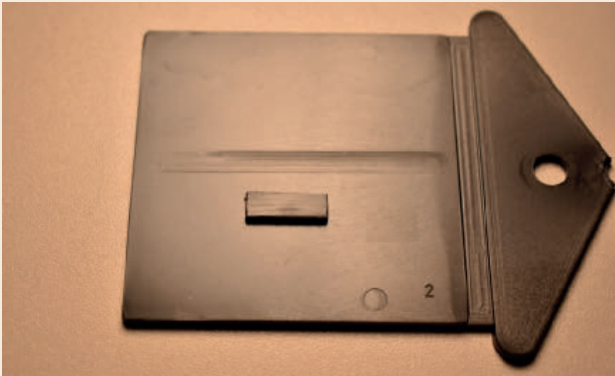
Bild 5 Reibpaarung 7 (ASA+PA TF GF vs. PC+ABSTF) nach Versuchsende Foto: Triboplast
