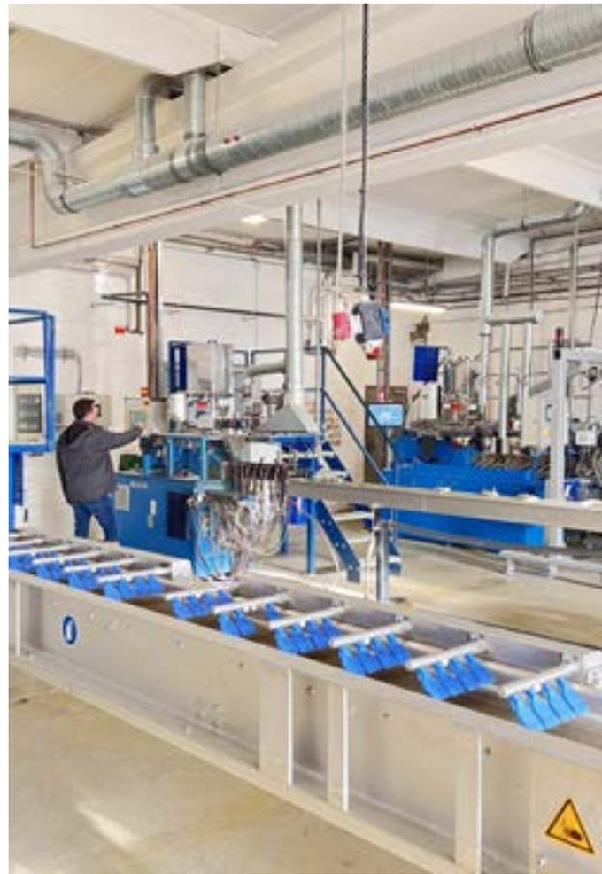
**Gravimetrische Dosierungen** mit optimalen Schnecken, auswählbar nach Riesel- und Förderfähigkeit sowie nach angestrebter Ausbringleistung, flexible Positionierung der Dosierung an allen Zugabestellen möglich, Zugabe-Optionen für:
